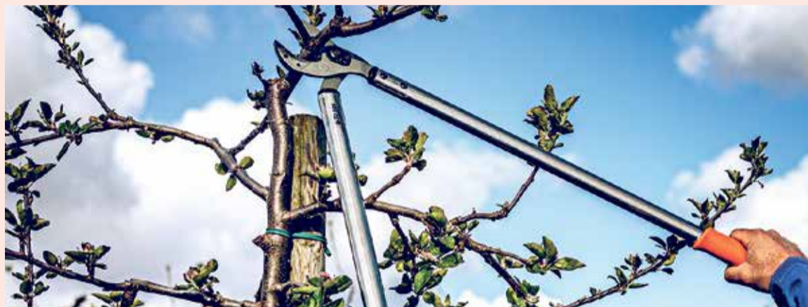
Eine Astschere mit Amboss-Prinzip dient als verlängerter Arm, wenn die Äste zu hoch sitzen. Foto: Gebr. Schröder GmbH/akz
