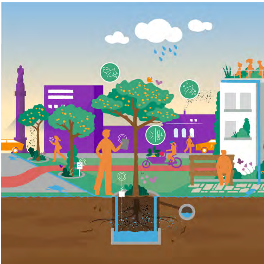
Abbildung 61: Schematisches Beispiel eines wasseroptimierten Baumstandortes. Quelle: Wissenschaftsstadt Darmstadt, Layout von SCHUMACHER
