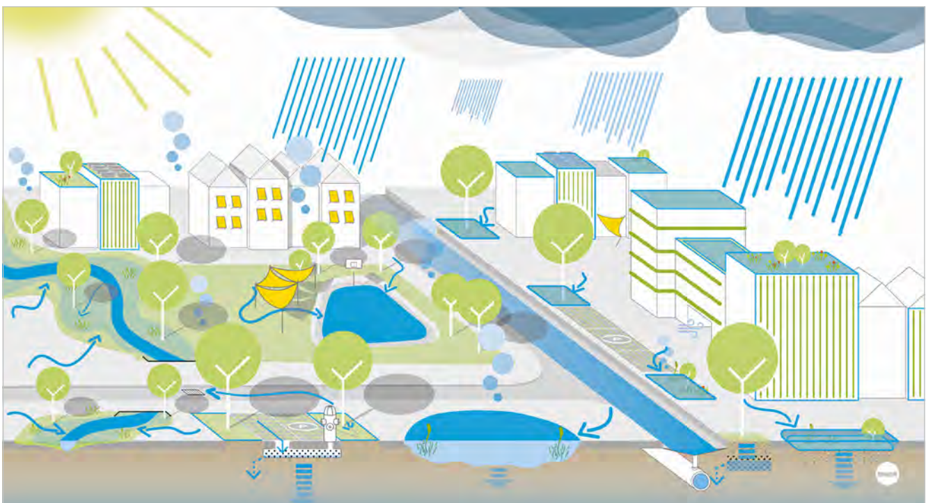
Abbildung 51: Elemente des Schwammstadtprinzips. Quelle: MUST Städtebau
