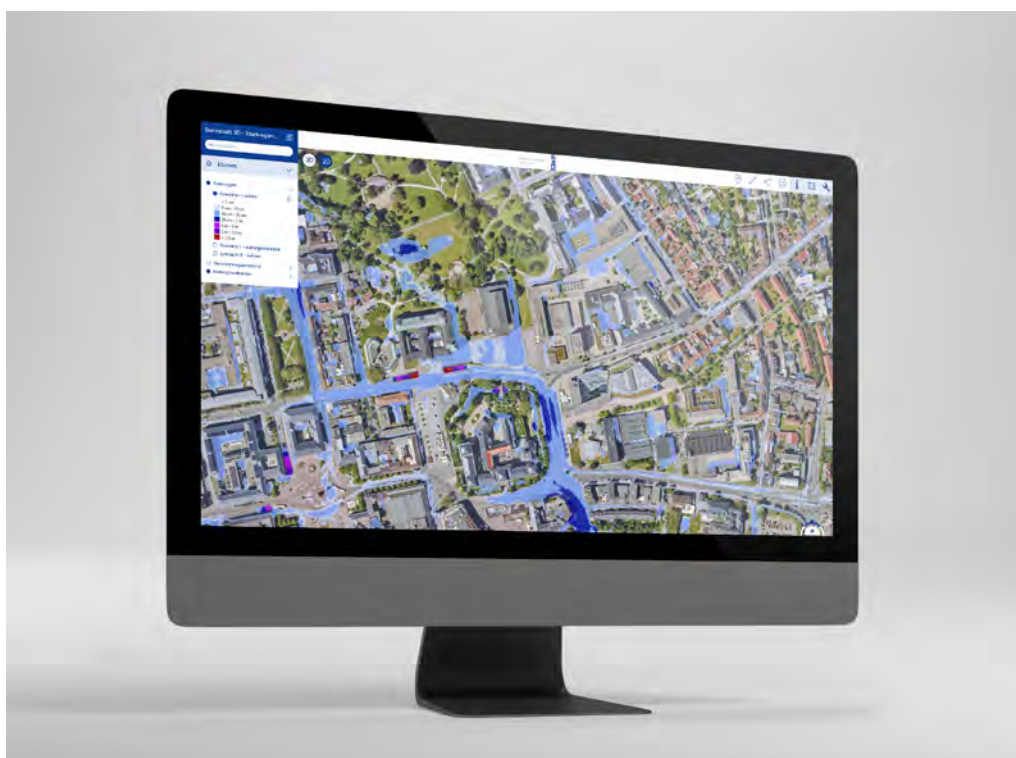
Abbildung 90: Starkregengefahrenkarte mit überfluteten Bereichen unter Annahme eines seltenen Starkregenereignisses, Kartenausschnitt Stadtzentrum. Quelle: Wissenschaftsstadt Darmstadt. Daten: DAHLEM Beratende Ingenieure Ingenieure GmbH & Co. Wasserwirtschaft KG
