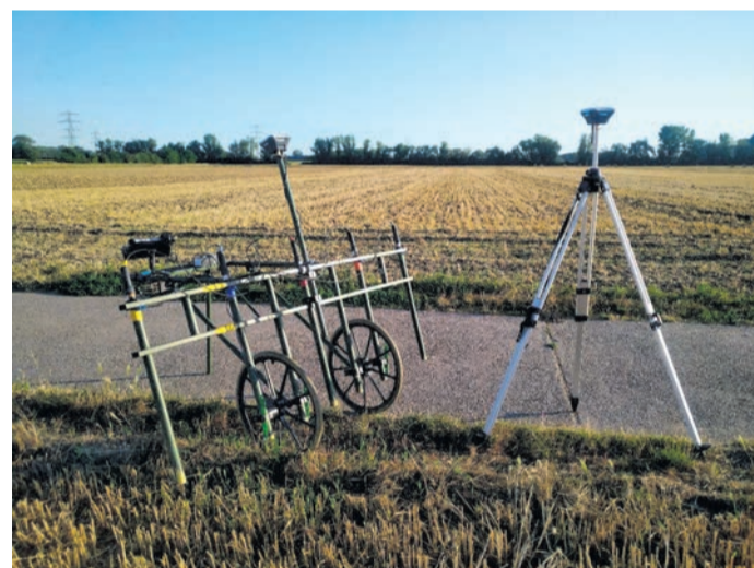
Das Erfassungsinstrument auf Fahrradreifen belastet den Boden minimal. Es wird gezogen - entweder mit einem Quad oder bei feuchten Untergründen zu Fuß. (Foto: Mertl, SPAU GmbH)
