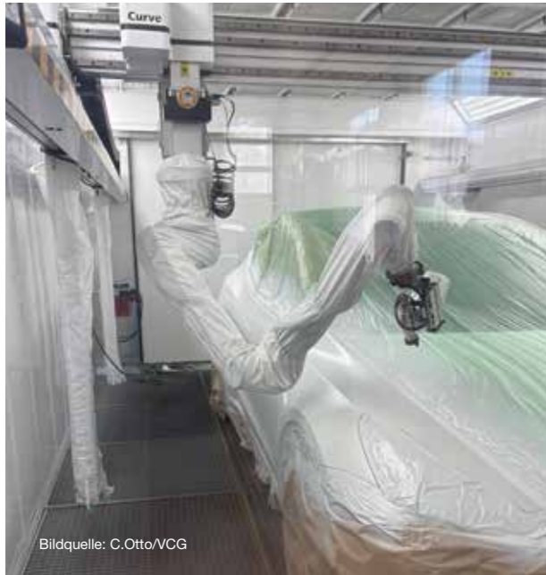
Lackierroboter beim Einsatz in der Lackierkabine
