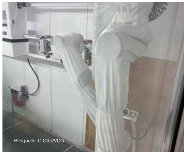
Selbständige Reinigung der Lackierpistole
