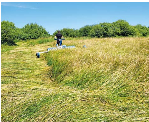
Zur Landschaftspflege von wiedervernässten Wiesen ist spezielle Technik notwendig. Zu sehen ist ein Einachsmäher auf Stachelwalzen, mit einer Arbeitsbreite von 3,5 m und einer Arbeitsgeschwindigkeit von ca. 7 km/h, bei der Nasswiesenmahd auf der Klimafarm der Stiftung Naturschutz in Schleswig-Holstein.
