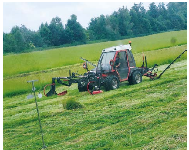
Hat es besonders leicht: Hangtauglicher Geräteträger mit Doppelmesserbalkenmähwerk (Front und Heck, Schmetterling) bei der Mahd einer Nasswiese im Allgäu. Das Gesamtgewicht beträgt nur etwa 3 Tonnen bei einer Arbeitsbreite von 8,5 m.
