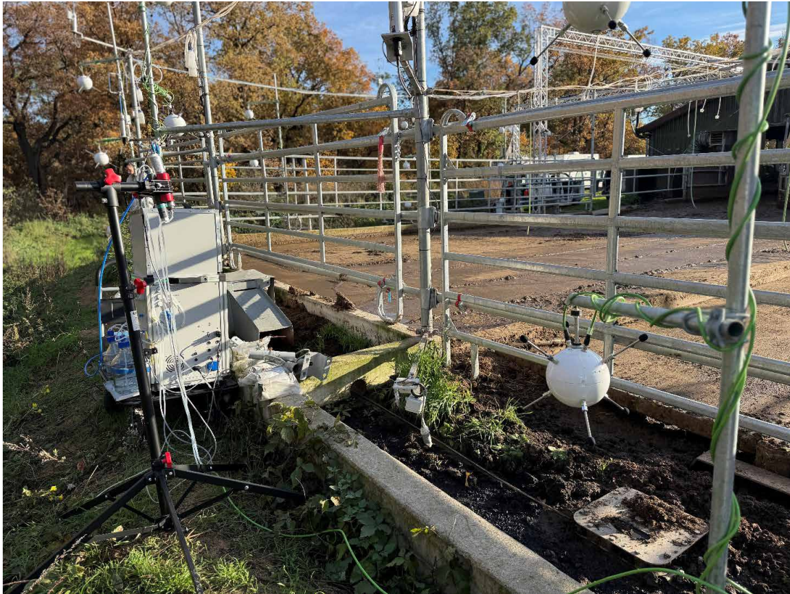
Abb. 1: Automatischer Bioaerosolsammler und weitere Emissionsmesstechnik aus dem EmiMod-Projekt an einem Laufhof für Rinder (© S. Bromann, Thünen-Institut).
