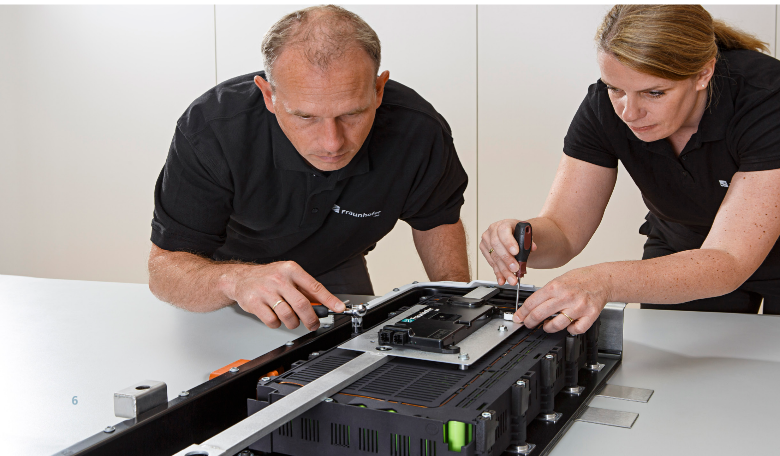
Abb. 2: Dismantling der Batterien von Elektrofahrzeugen für eine 2nd-Life Anwendung.
